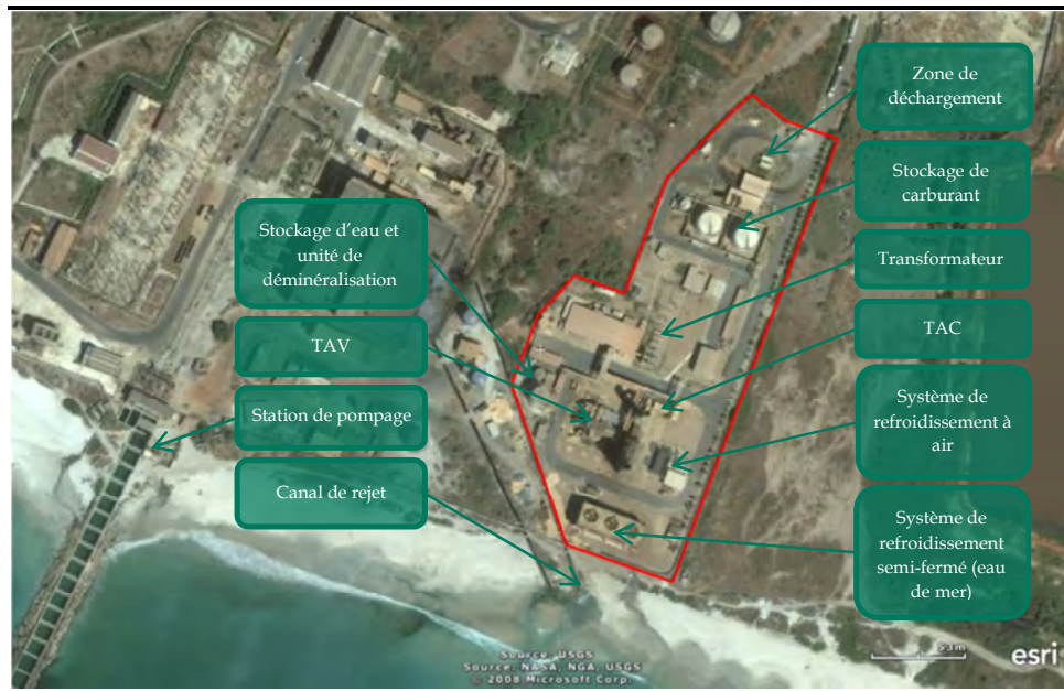
Figure 4.1 Principales installations de la centrale thermique existante
